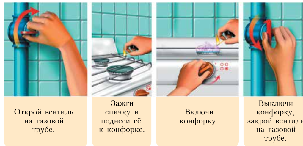
Рис. 52. Порядок включения и выключения газовой конфорки
