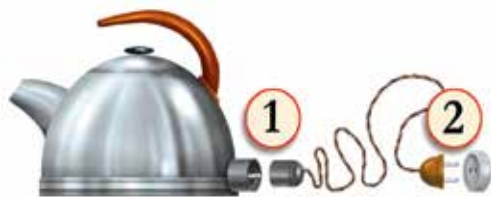
Рис. 51. Порядок включения электроприбора
